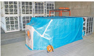
写真 現地貯蔵庫での試験(工場扇を用いて排気し、後方から吸気している)
